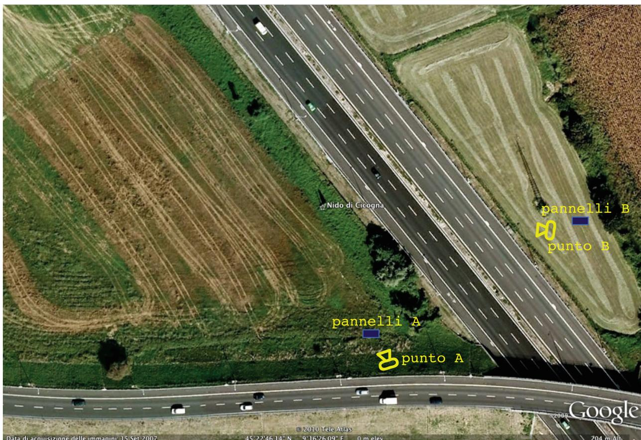
Mentre per il punto A è indispensabile pensare a un sistema di alimentazione autonomo e fotovoltaico, per il punto B è pensabile il realizzare un sistema con il quale operatori sostituiscono e ricaricano in luogo separato i pacchi batteria ogni 2/3 giorni durante il periodo di attività dell'installazione.
